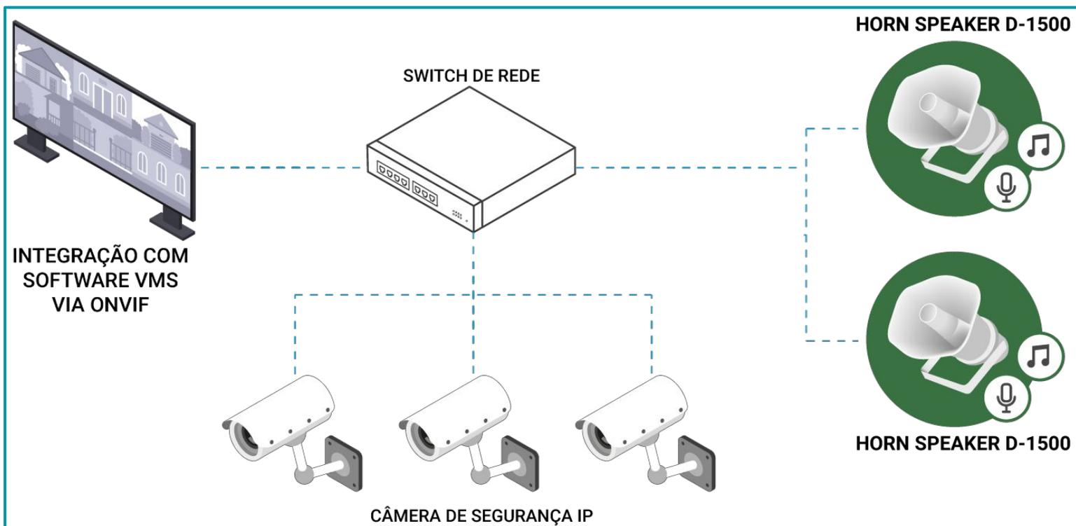
**Legenda:** A Horn Speaker D-1500 emite sons no ambiente e pode auxiliar no controle do local através do software VMS via protocolo ONVIF.
