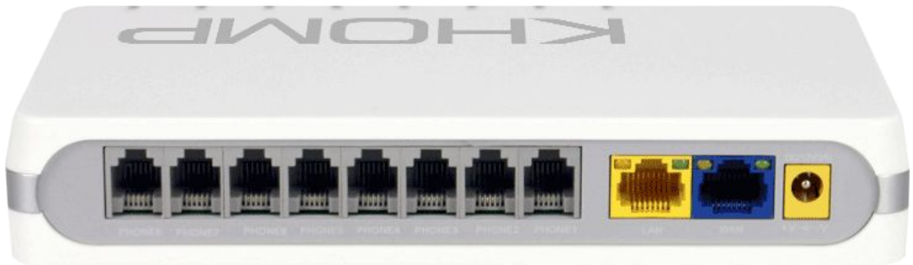
Vista posterior con puertos FXS, puertos LAN y WAN, y entrada de fuente de alimentación.
