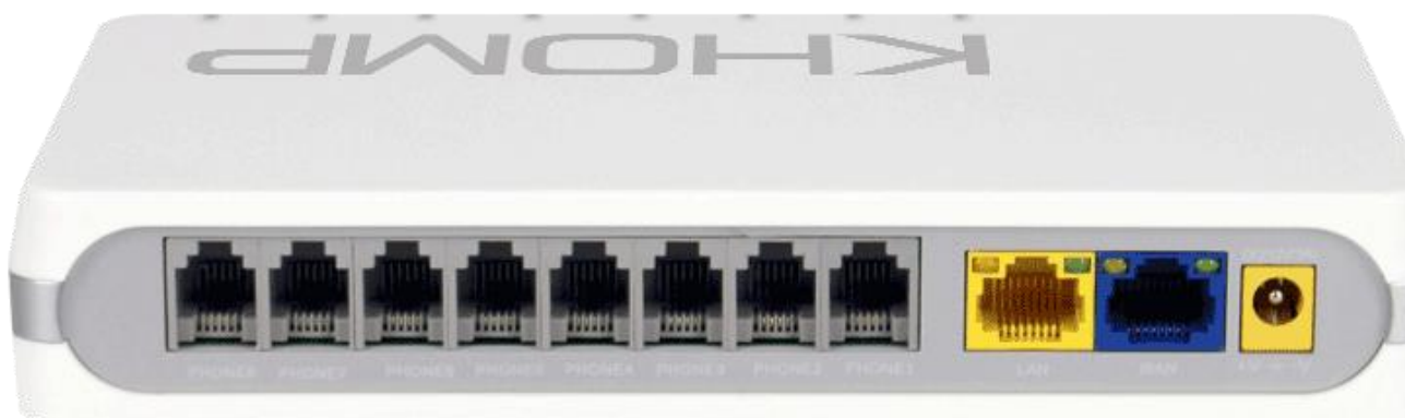
Visão traseira – com 8 portas FXS, 1 porta LAN, 1 porta WAN e entrada para fonte de energia
