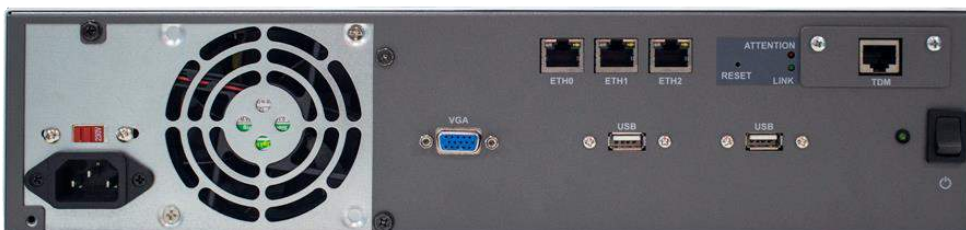
Visão traseira – Link E1/T1 com conector RJ45
