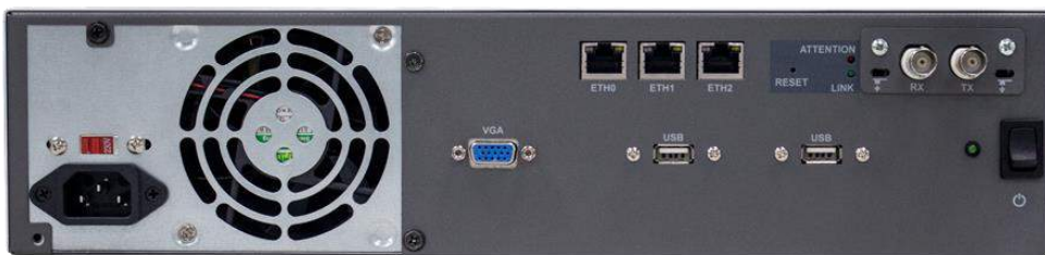
Vista posterior – Enlace E1/T1 con conector BNC coaxial
