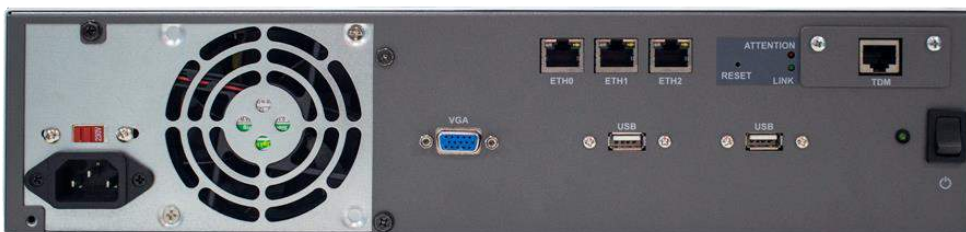
Vista posterior – Enlace E1/T1 con conector RJ45
