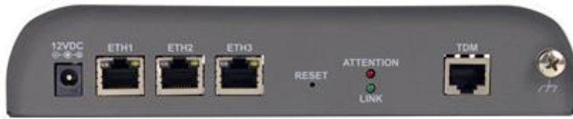
Vista posterior – Enlace E1 con conector RJ45
