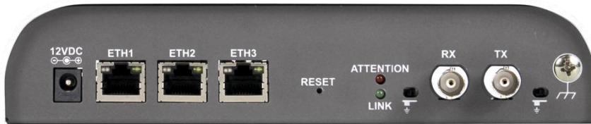
Vista posterior – Enlace E1 con conector BNC coaxial
