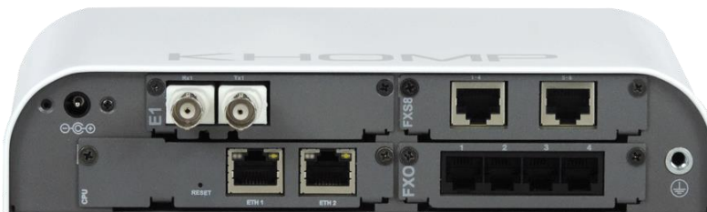
Vista posterior con 1 E1, 8 FXS y 4 FXO
