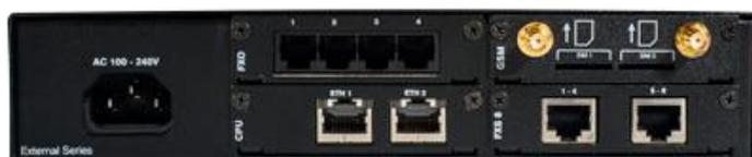
Exemplo de montagem com 4 FXO, 2 GSM e 8 FXS.
