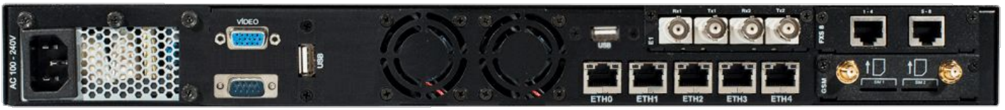
Subtítulo: Vista posterior con 2 enlaces E1 (ranura 1), 8 FXS (ranura 2) y 2 GSM (ranura 3).
