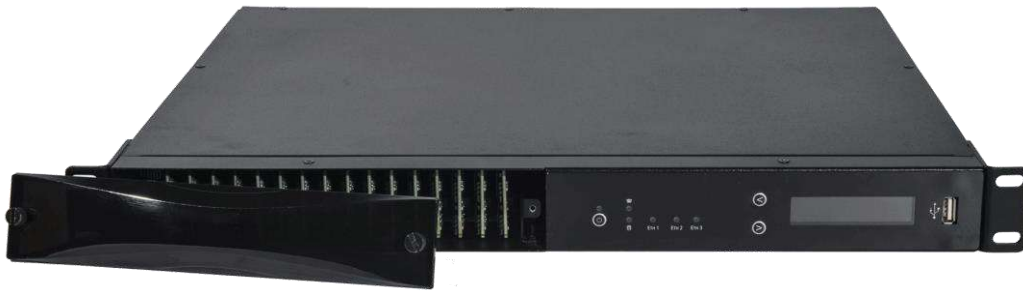
Visão frontal com tampa aberta para troca dos SIM cards
