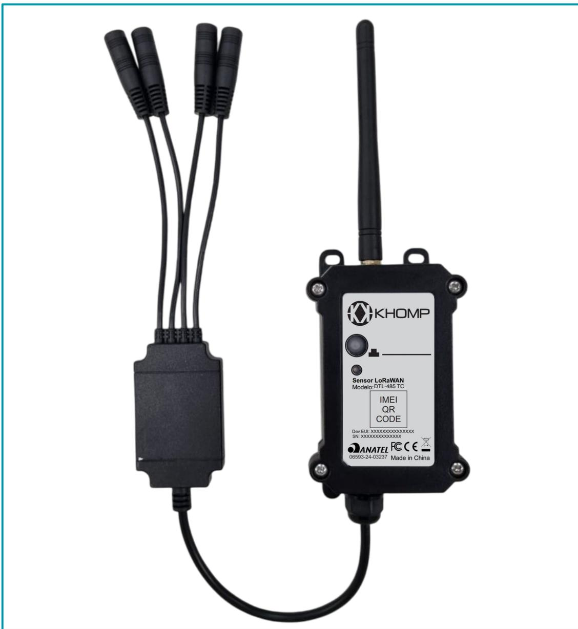
**Legenda:** DTL-485 TC integrado no Módulo Transformador de Corrente.
