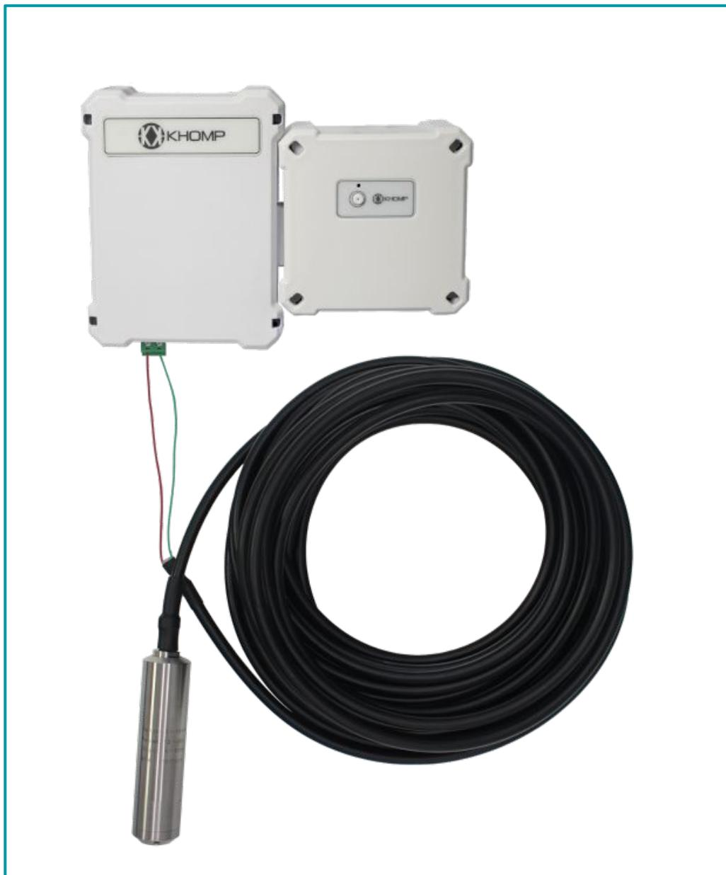
**Legenda:** Na imagem, observamos o Sensor de Nível para Líquidos conectado na extensão modular EM C104. O sistema está integrado ao Endpoint IEEE 802.15.4 para transmissão dos dados na rede sem fio ao gateway ITG.
