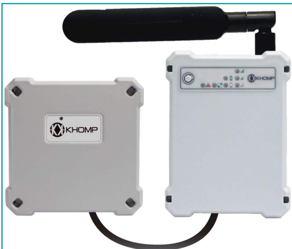
Legenda: É observada a conexão da extensão modular EM THW 200 na lateral do ITS para constatar temperatura, umidade, luminosidade e ruído. O ITS 402 envia os dados para a nuvem/servidor MQTT através da antena GSM indoor.
