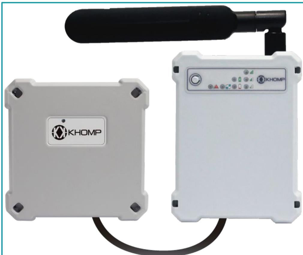
**Leyenda:** Se observa la conexión de la extensión modular [EM THW 200](#) en el costado del ITS para verificar temperatura, humedad, luminosidad y ruido. El ITS 402 envía los datos al servidor en la nube/MQTT a través de la antena GSM interior.
