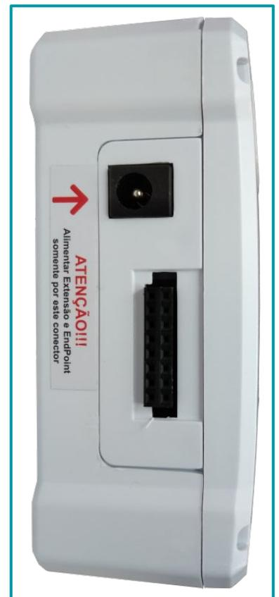
**Legenda:** La imagen de arriba muestra el conjunto de productos real (ITS 402 está integrado en la extensión modular EM R102). La imagen al costado, indica el costado de la extensión modular EM R102, donde se encuentra el conector para expansión del sistema y el lugar para conectar la fuente de alimentación.
