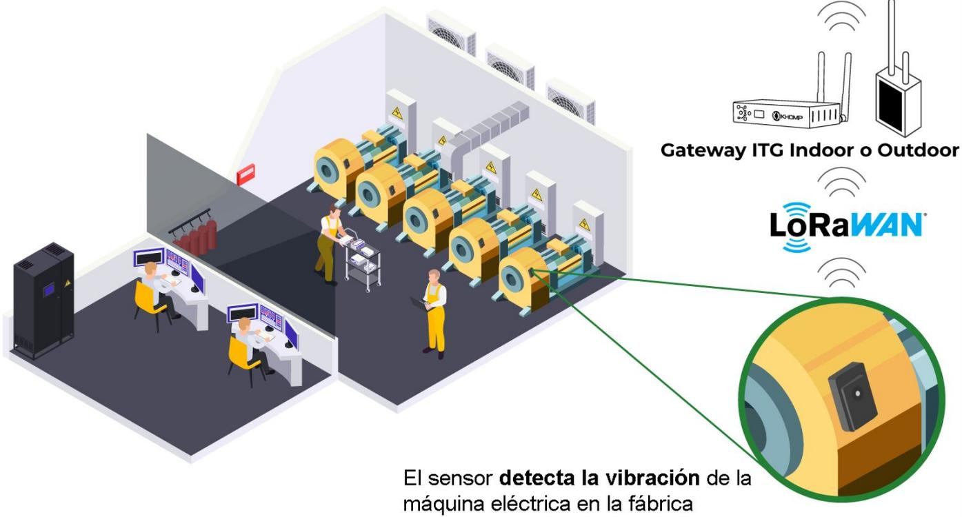
**Leyenda:** NIT 21LV midiendo el nivel de vibración y constatando la temperatura/humedad. Este monitoreo es esencial para el mantenimiento preventivo de la máquina eléctrica, proporcionando mayor vida útil de la maquinaria industrial.
