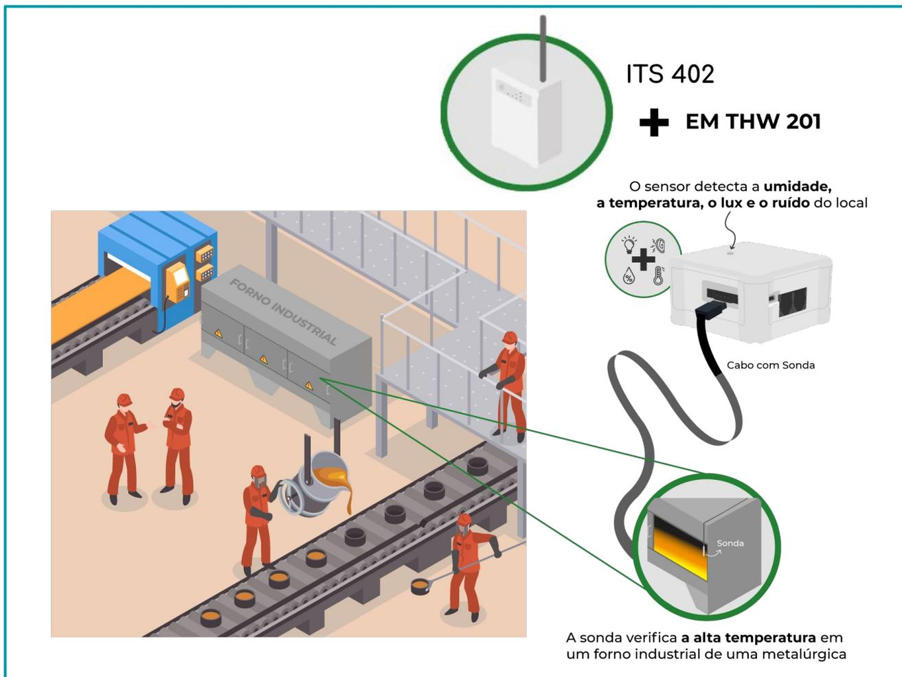
**Legenda:** A imagem acima indica o modelo de aplicação para monitoramento da umidade, da temperatura e do ruído em uma indústria metalúrgica.
