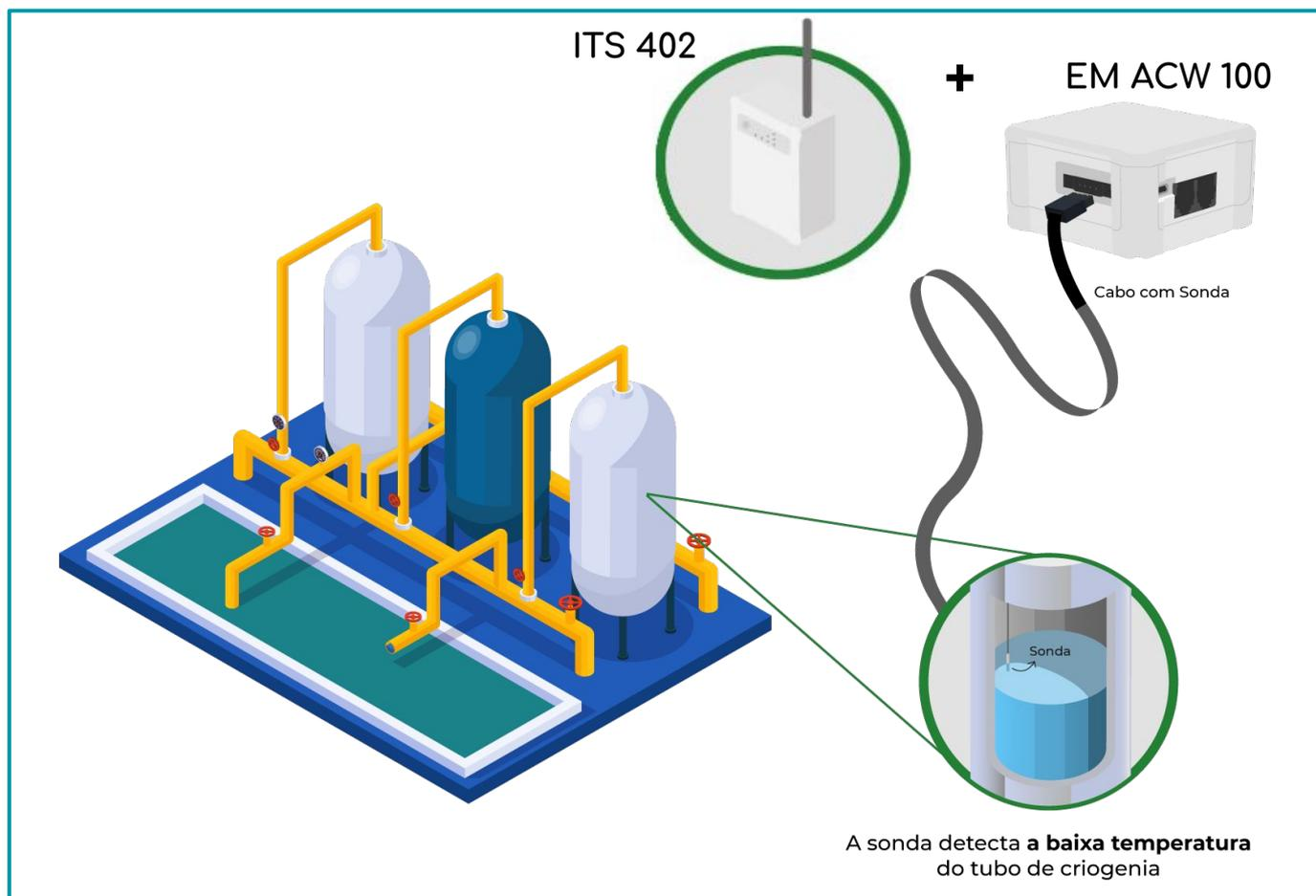
**Legenda:** A imagem acima indica o modelo de aplicação para monitoramento da temperatura em um tubo de criogenia.
