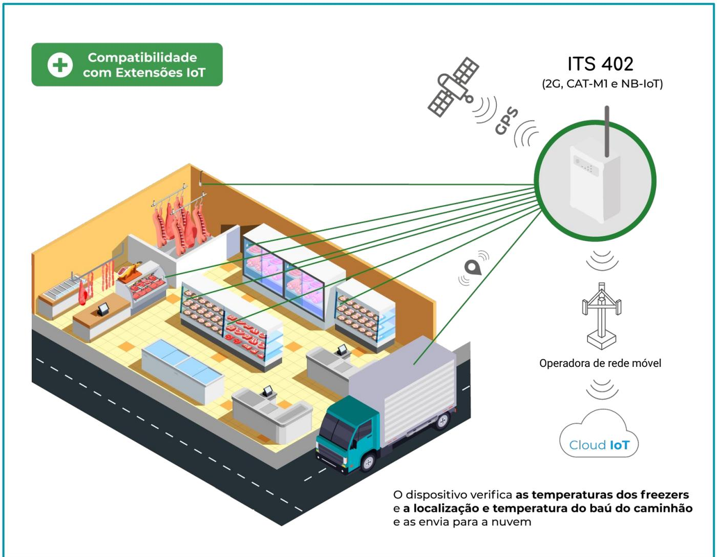
**Legenda:** Neste modelo de aplicação, são utilizados vários ITS 402 com extensões modulares para constatar as temperaturas nos freezers do açougue e a localização/temperatura do caminhão de transporte da carga refrigerada.
