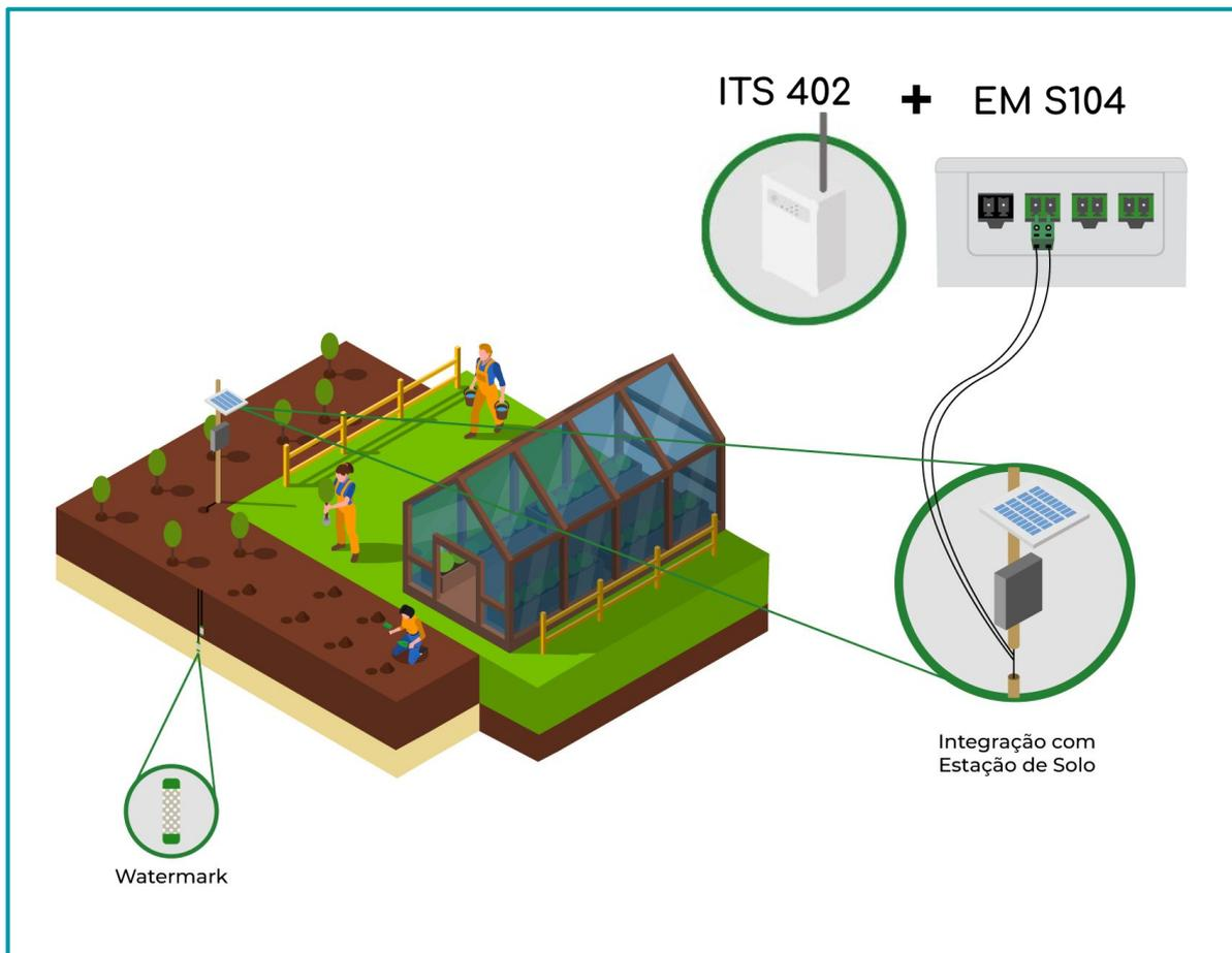
**Legenda:** A imagem acima indica o modelo de aplicação para monitoramento da umidade e da temperatura do solo.
