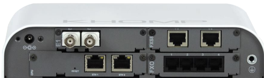
Vista posterior com 1 E1, 8 FXS e 4 FXO
