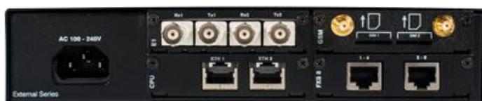
Ejemplo de montaje con 2 E1, 2 GSM y 4 FXO.
