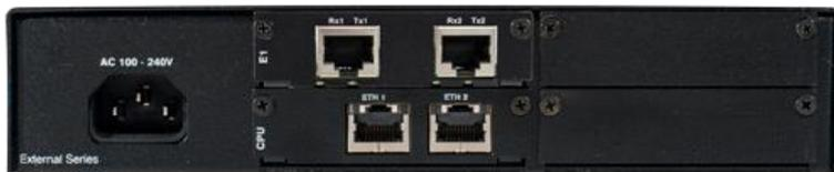
Vista posterior del modelo con 2 enlaces E1/T1 (RJ45).
