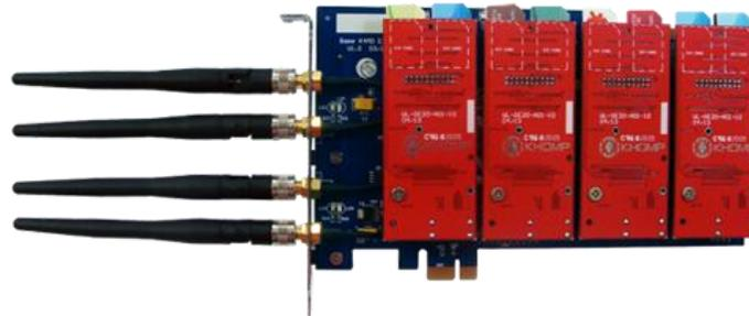
A placa KGSM pode ser adquirida no modelo Express, compatível com interface PCI-E 1x ou superior, com tecnologia DMA. Na versão Express, a KGSM tem capacidade para até 2 chips por módulo, os quais são inseridos pela borda superior da placa e ficam na parte interna do servidor, protegidos contra furto ou uso indevido. A placa funciona com chip de qualquer operadora de celular GSM nacional, inclusive com chips diferentes no mesmo módulo.
