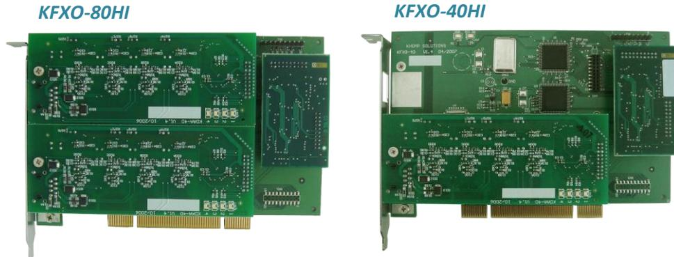
As placas KFXO-HI (KFXO-80HI e KFXO-40HI) têm como principal função a gravação passiva em alta impedância de ramais de PABX ou linhas telefônicas analógicas. Elas são conectadas em paralelo com o telefone, realizando a gravação de forma imperceptível para os usuários e sem degradar o áudio da ligação.
